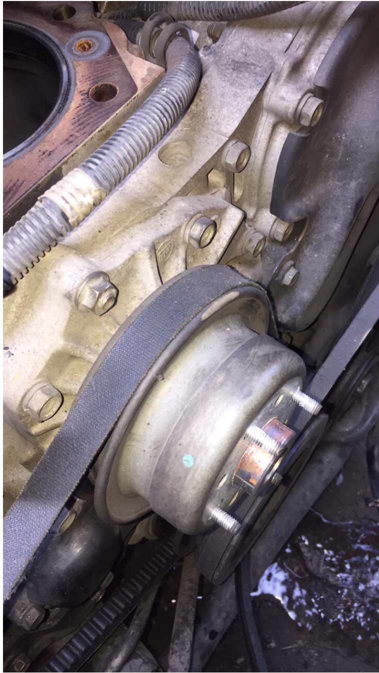
รูปภาพที่ 9 ปั้มน้ำเสื่อมสภาพ#
