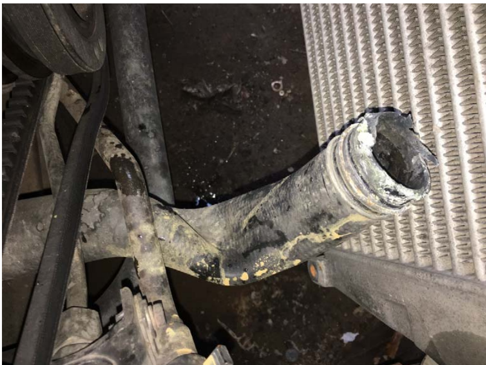
รูปภาพที่ 6 ท่อน้ำบน#
